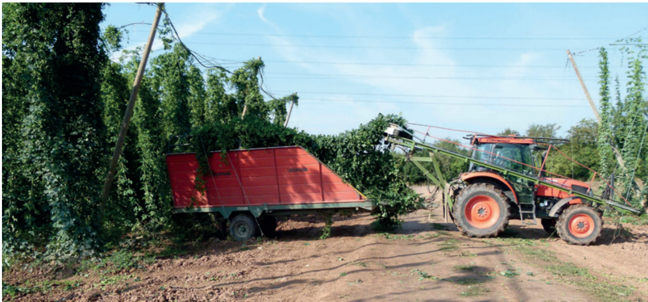
Een hopoogstmachine plukt de hopranken inclusief leidraden en verhakselt de opbrengst.
